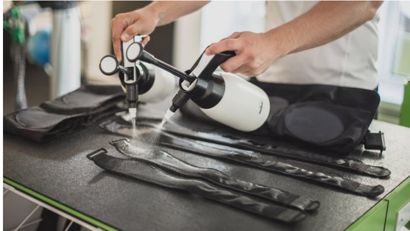
Damit der Strom besser fließt, wird Wasser auf die Elektroden gesprüht. © Carolin Weinkopf für ZEIT ONLINE
